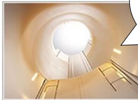
広いボアには、調整式ボア内 LED 照明を設置。薄暗い環境ではなく明るい環境下での撮影が可能です。また、調整式ボア内送風機も搭載しておりますので、より快適な検査環境を実現しています。
